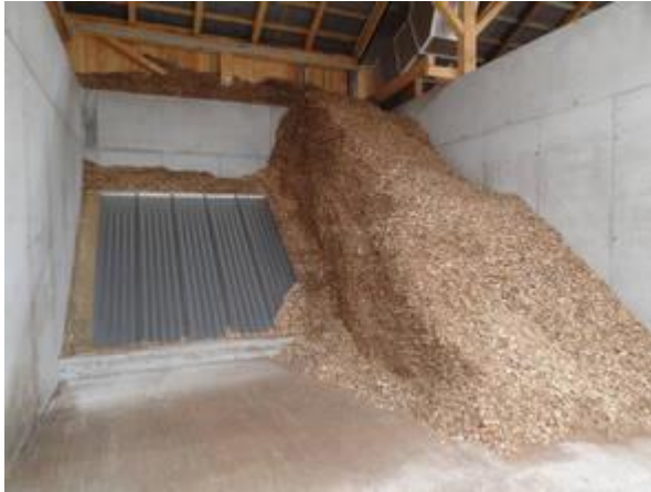
Abbildung 199: Beispielhafte Darstellung eines für das Projekt "Hackgutttrocknung Reich" installierter Schrägrost-Hackgutttrockner (Quelle: www.cona.at )
