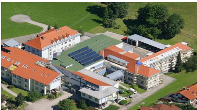
Abbildung 209: Luftaufnahme des „Unfallkrankenhauses Kalwang“ (links, Bildquelle: AUVA) und Ausschnitt der Gebäudeansicht mit der 208 m 2 umfassenden Kollektoranlage (rechts, Bildquelle: AEE INTEC)
